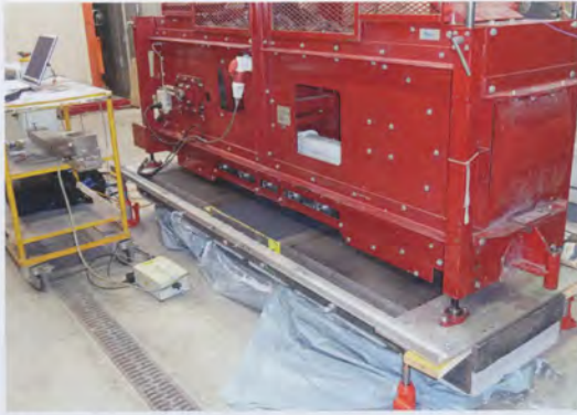
Verkehrssimulatoren: Diese Maschinen sind in der Lage, Überrollbeanspruchung von real auftretendem Verkehr zu simulieren. Oben: MMLS3 für die skalierte Analyse von Fahrbahnübergängen/Strassenbelägen bei der Überrollung eines Testobjektes. Unten: MLS10 zur Simulation von «1:1»-Verkehrsbelastungen mit grobem Funktionsprinzip.
