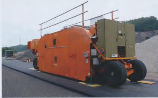
Verkehrssimulatoren: Diese Maschinen sind in der Lage, Überrollbeanspruchung von real auftretendem Verkehr zu simulieren. Oben: MMLS3 für die skalierte Analyse von Fahrbahnübergängen/Strassenbelägen bei der Überrollung eines Testobjektes. Unten: MLS10 zur Simulation von «1:1»-Verkehrsbelastungen mit grobem Funktionsprinzip.
